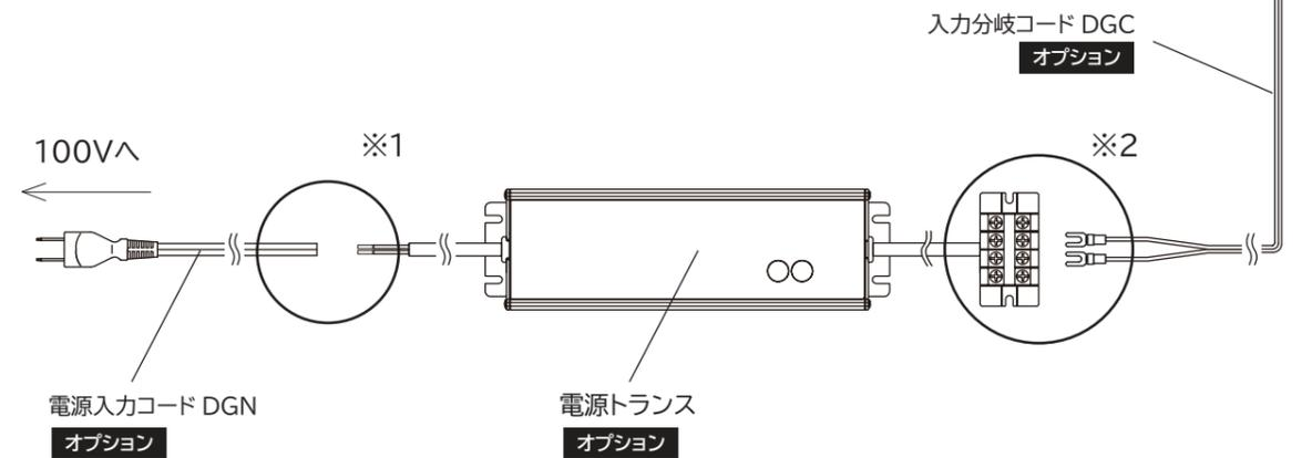
※1 電源コードを直結した箇所は確実に絶縁処理を実施下さい。
