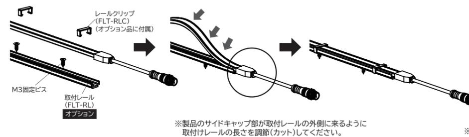
※製品のサイドキャップ部が取付レールの外側に来るように取付けレールの長さを調節(カット)してください。
