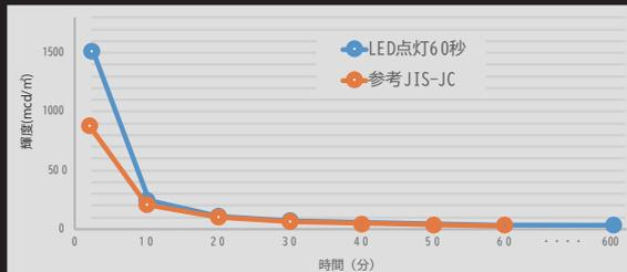
LED消灯後約10時間経過後も3mcd/m<sup>2</sup>以上の輝度が持続し、発光部が視認できる状態を保持しています。
